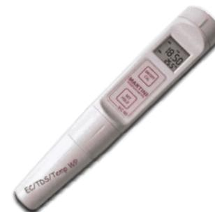
Il Conduttivimetro EC60 garantisce una lettura della conducibilità elettrica estremamente precisa.
